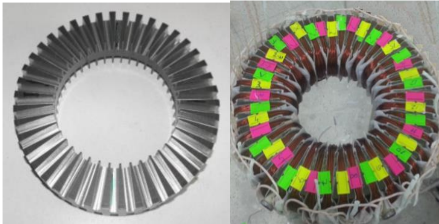
Şekil 3.15 : Sargısız ve sarım yapılmış stator.
