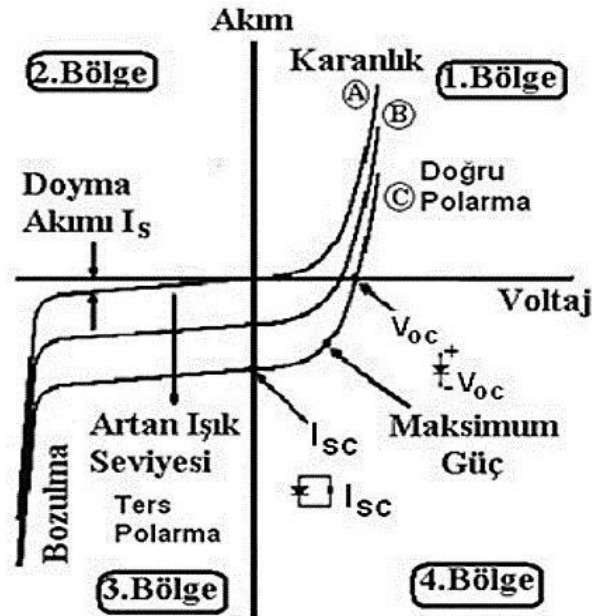
Şekil 2.17 : Fotodiyotun karanlık ve aydınlatılmış durumlardaki akım-voltaj karakteristiki [89,90].
