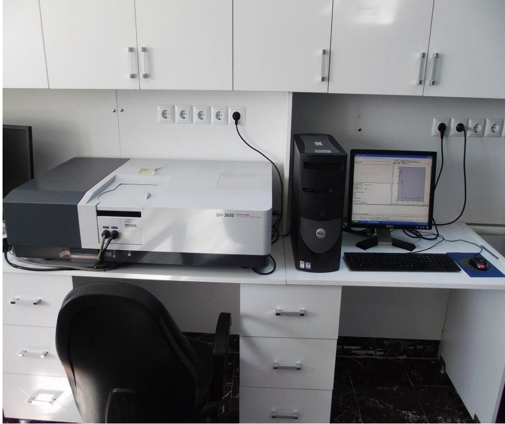
Şekil 3.2 : Katkısız CdO ve Mn katkılı CdO ince filmlerin U-V ölçümleri için kullanılan UV-VIS spektrofotometre cihazı
