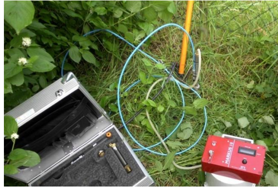
Şekil 2.17 : MARKUS 10 ile radon ölçümü (Url-3).
