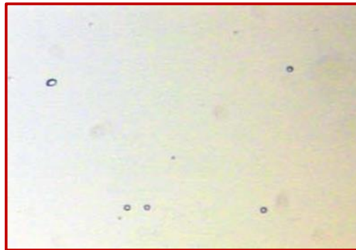
Şekil 2.18 : CR-39 dedektörü ile radon ölçümünde oluşan alfa parçacıkların bıraktığı izlerin mikroskop görüntüsü (Banjanac, 2006).
