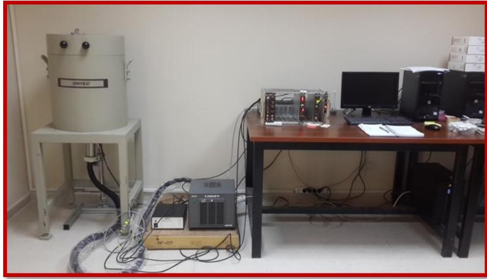
Şekil 3.6 : Ortec GEM 70P4-95 model HPGe dedektörlü gama spektrometre sistemi.
