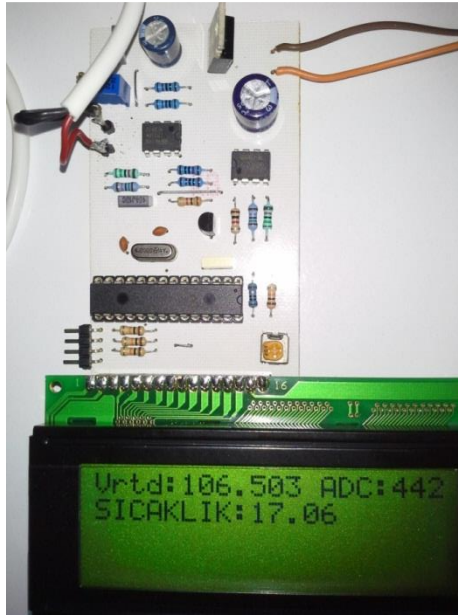
Şekil 11: PT100'e ait değerler için örnek değerlendirme
