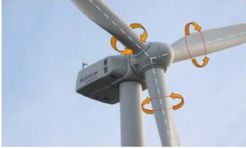
Şekil 3.19: Hatve mekanizması (Kanat açısı ayarlama)[71].
