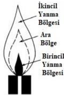
Şekil 3.13 : Bir alev profilinin bölgeleri [41].
