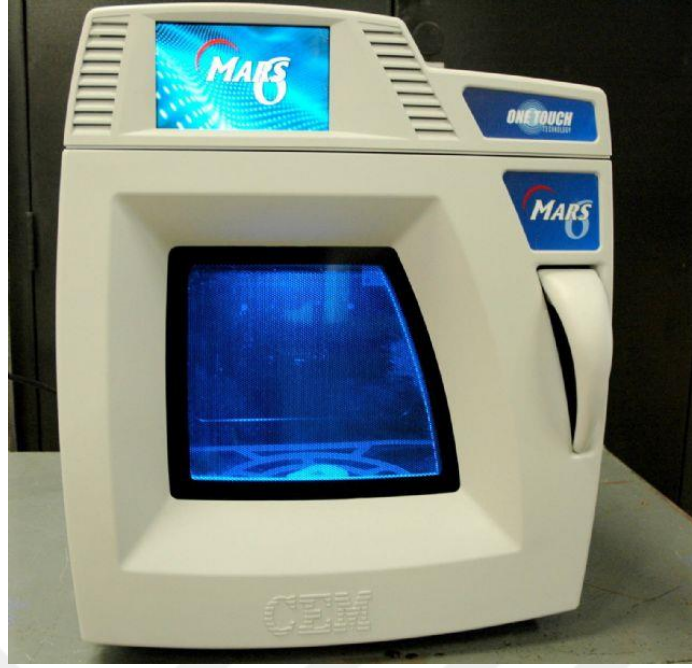
Şekil 4.9 : Örnek çözünürleştirme işlemleri için laboratuvarında kullanılan mikrodalga cihazı (orjinal).
