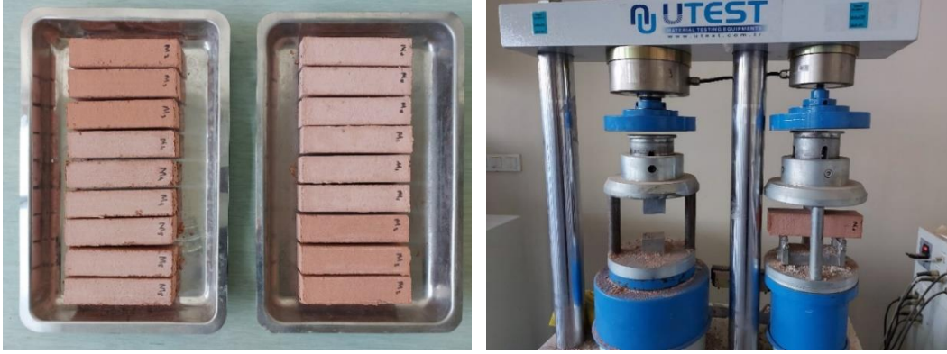
Şekil 3. Horasan harcı örnekleri ve eğilme dayanım deneyi
