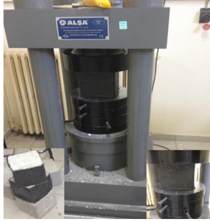
Şekil 2: Basınç Dayanımı (Beton Presi) Test Cihazı ve Numuneler
