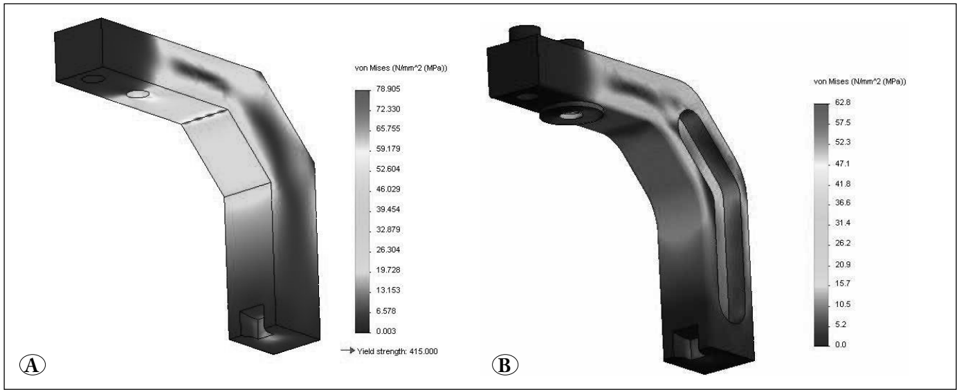
Şekil 9. A) Orijinal parçadaki gerilme dağılımı, B) tasarımı değiştirilen parçadaki gerilme dağılımı.
