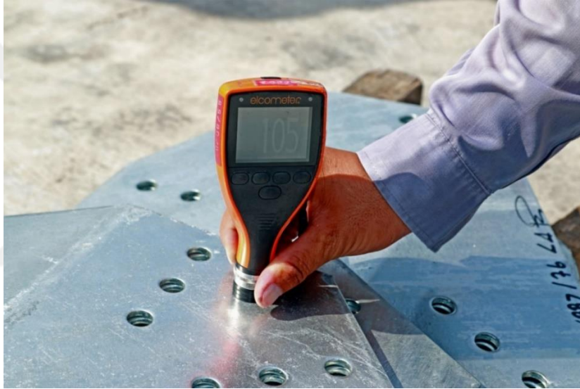
Şekil 3.20. Sıcak daldırma galvaniz kaplaması yapılmış ürün kaplama ölçümü
