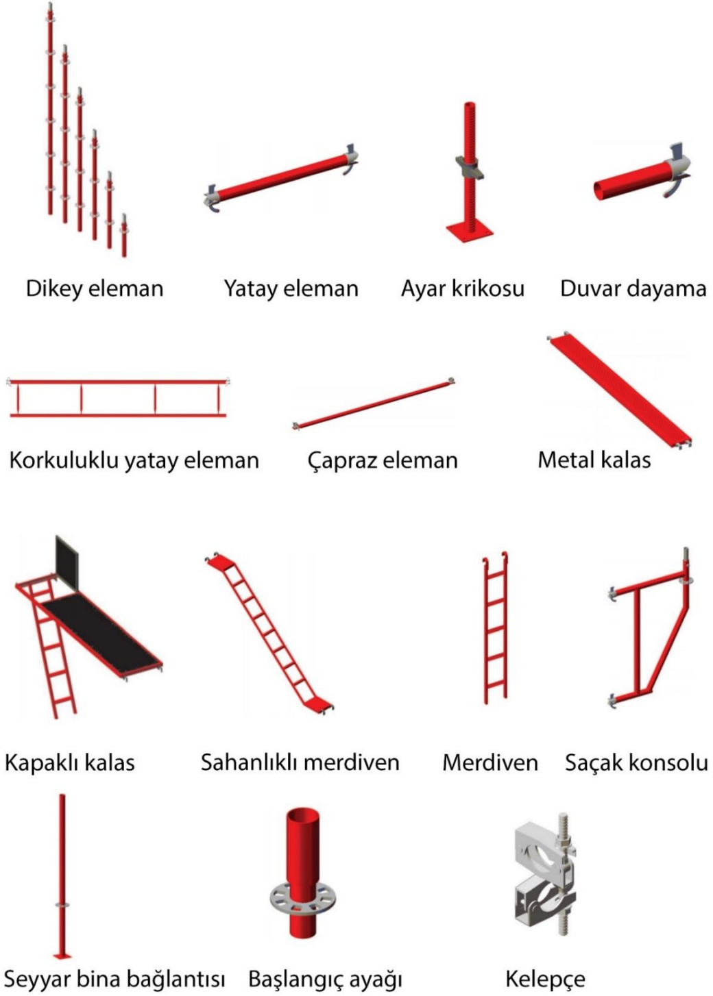
Şekil 3.10. Flaşlı iskele elemanları
