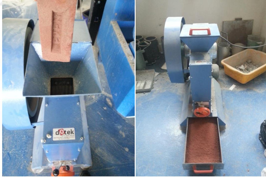
Resim 3.2. Harman tuğlası kırma işlemi
