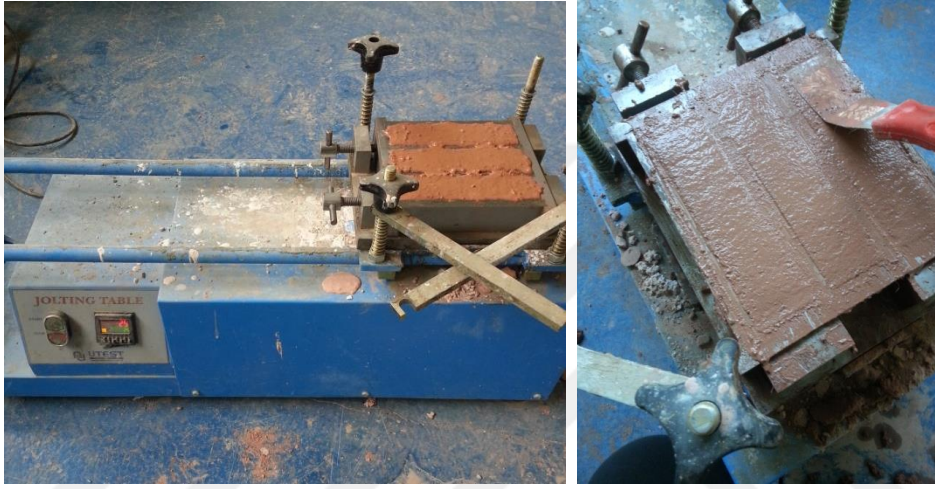
Resim 3.9. Sarsma tablası ve prizmatik kalıptaki numune
