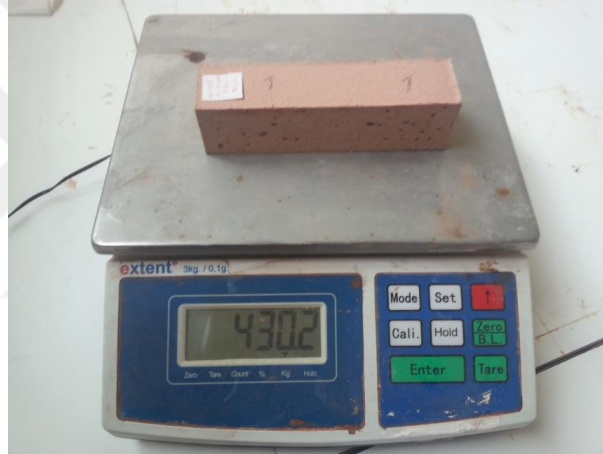
Resim 3.15. Birim hacim ağırlık deneyi
