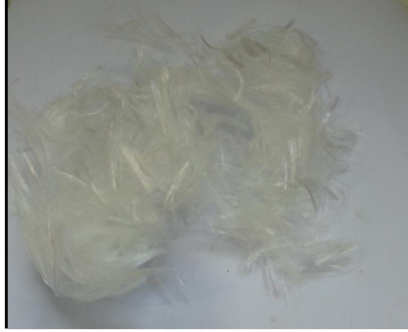
Resim 3.7. BF19 polipropilen elyaf lif
