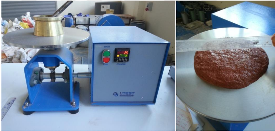
Resim 3.14. Yayılma tablası ile yayılma deneyi
