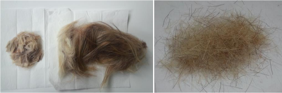
Resim 3.6. Deneysel olarak kullanılan 19 mm uzunluğunda kesilmiş keçi kılı örneği
