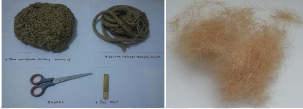
Resim 3.5. Kenevir lifinin 19 mm uzunluğunda kesilmesi işlemi
