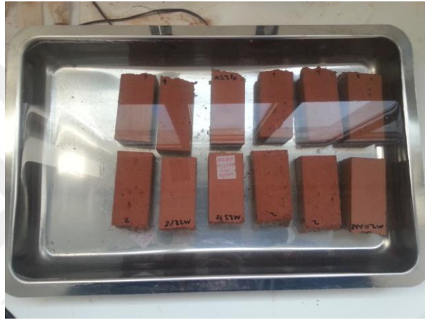
Resim 3.16. Su emme deneyi
