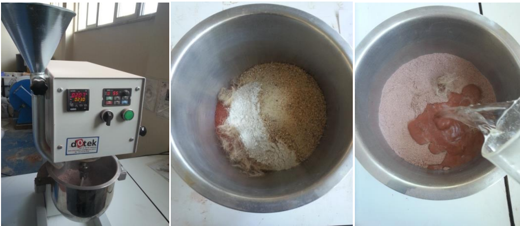
Resim 3.8. Horasan harcının kap içerisinde hazırlanması ve karıştırma cihazı
