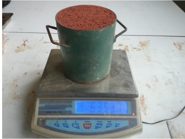
Resim 3.11. Birim hacim ağırlık deneyi
