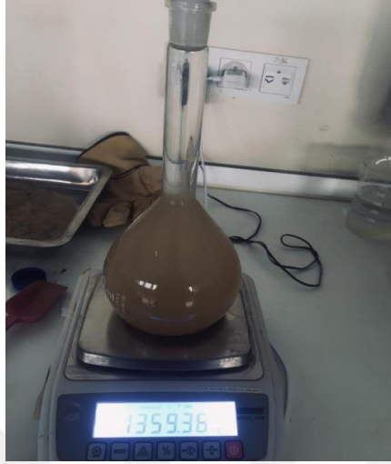
Resim 3.12. İnce agregada özgül ağırlık tayini
