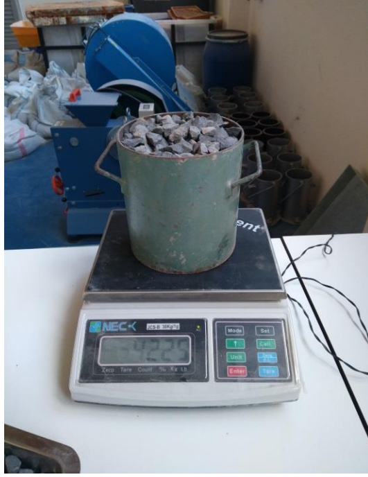
Şekil 5.7: Gevşek birim hacim ağırlık deneyi.
