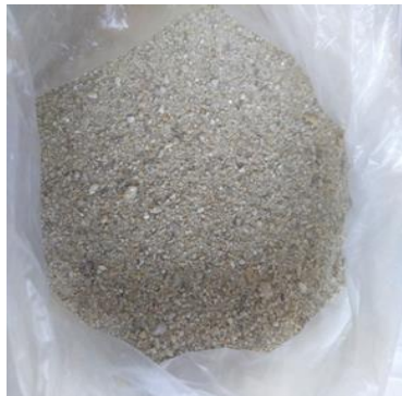
Şekil 5.6: Deneysel çalışmalarda kullanılan doğal kum.
