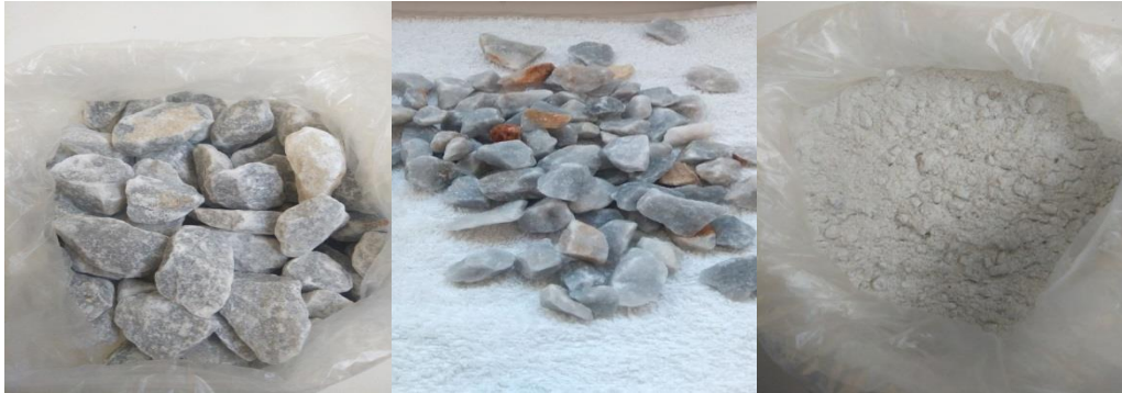
Şekil 5.3: Deneysel çalışmalarda kullanılan mermer agregaları.
