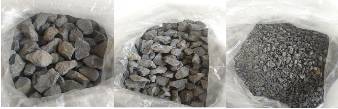
Şekil 5.2: Deneysel çalışmalarda kullanılan bazalt agregaları.
