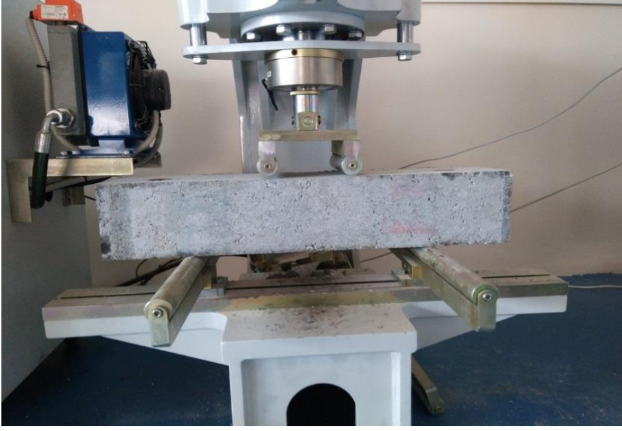
Şekil 5.19: Kiriş beton numune kırımının yapılması.
