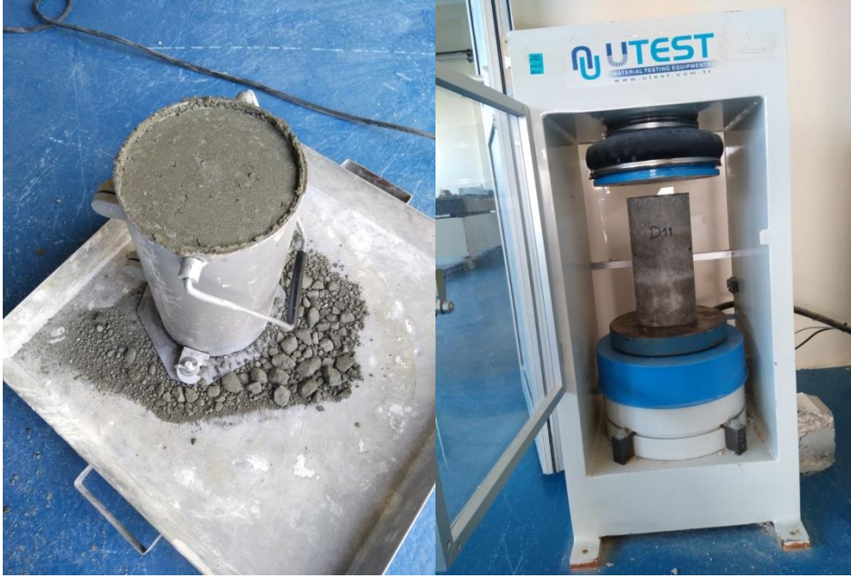
Şekil 5.16: Silindir beton numune üretimi ve kırımı.
