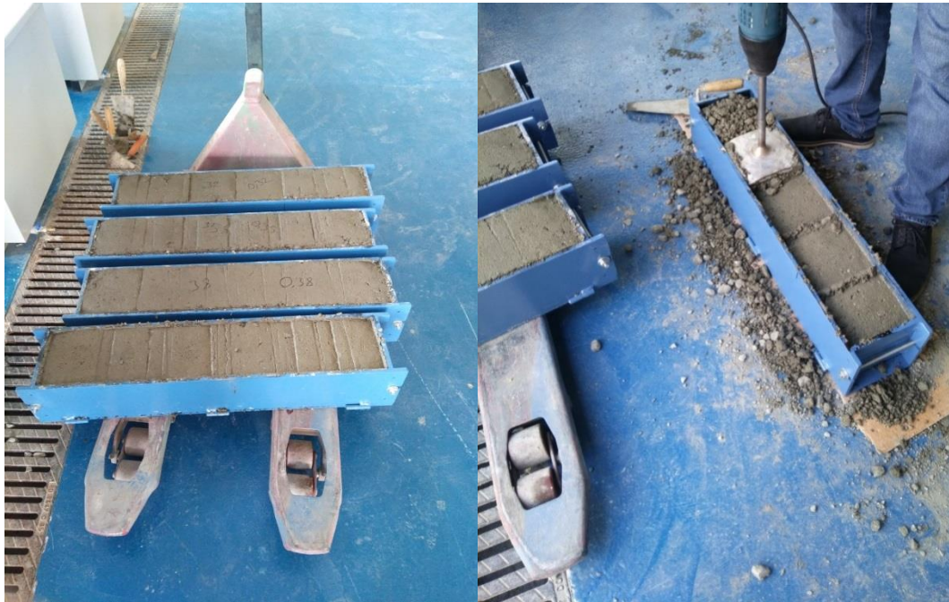
Şekil 5.18: Kiriş numune üretimi.
