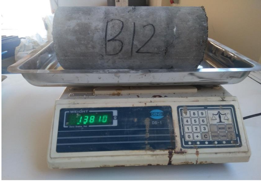
Şekil 5.15: Betonun birim hacim ağırlığının hesaplanması.
