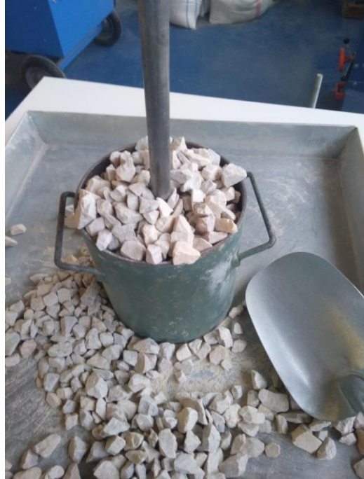
Şekil 5.8: Sıkışık birim hacim ağırlık deneyi.
