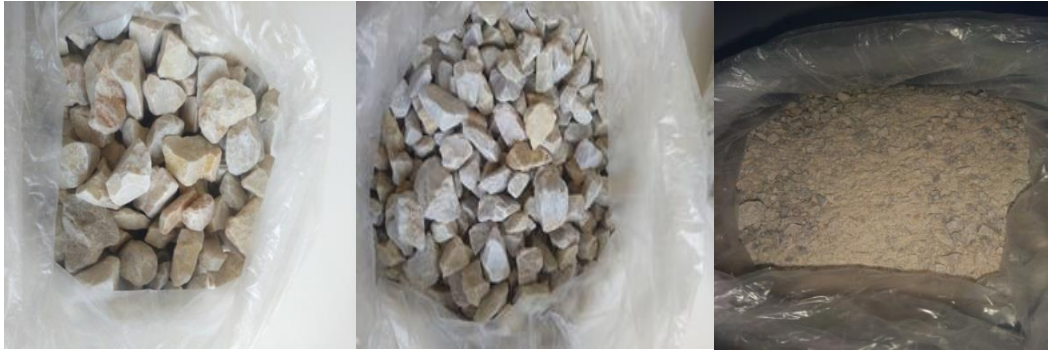
Şekil 5.5: Deneysel çalışmalarda kullanılan kalker II agregaları.
