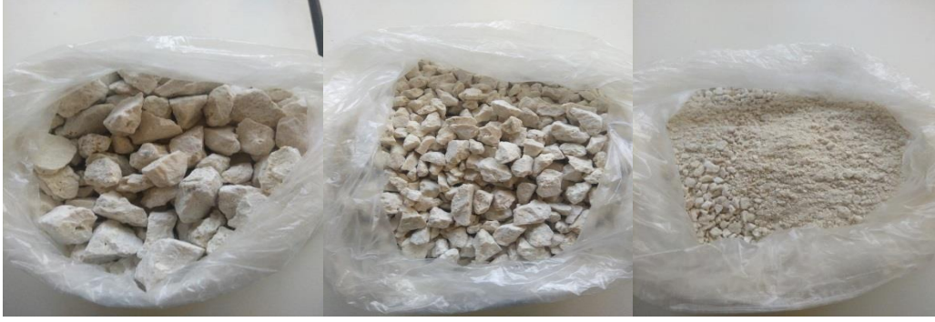
Şekil 5.4: Deneysel çalışmalarda kullanılan kalker I agregaları.
