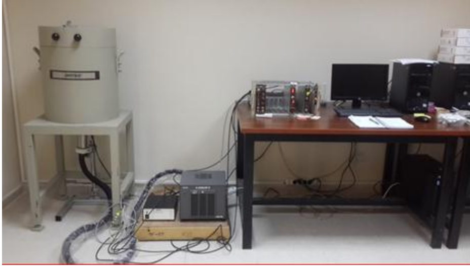
Şekil 3.5. Çalışmada kullanılan HPGe dedektörlü gama spektrometre sistemi (Özden, 2020)
